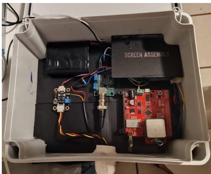
Figura 1 Caja Nema con tarjetas electrónicas. (fuente: elaboración propia)
