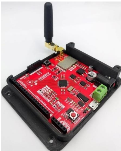
Figura 3 Tarjeta Sigfox para la comunicación. (zh.iotshop.mx)
